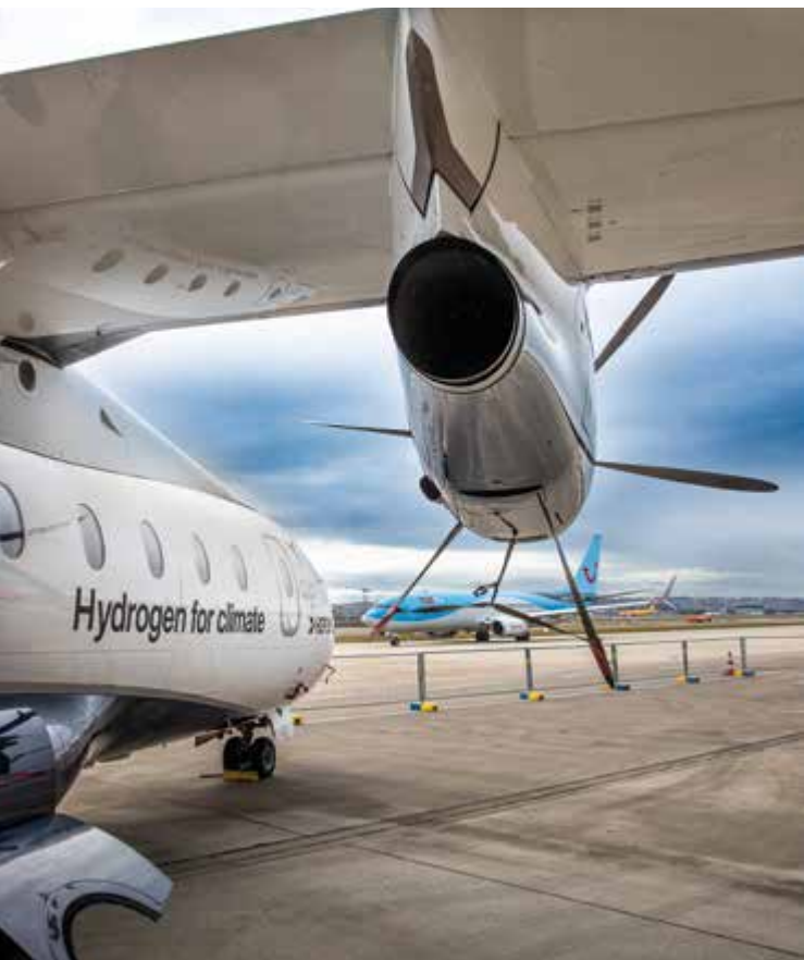
Eine 40-sitzige Dornier 328 mit Wasserstoff-Brennstoffzellen-Antrieb und einer Reichweite von bis zu 2.000 km ist aktuell in der Entwicklung. Schon in ein paar Jahren soll sie abheben.
